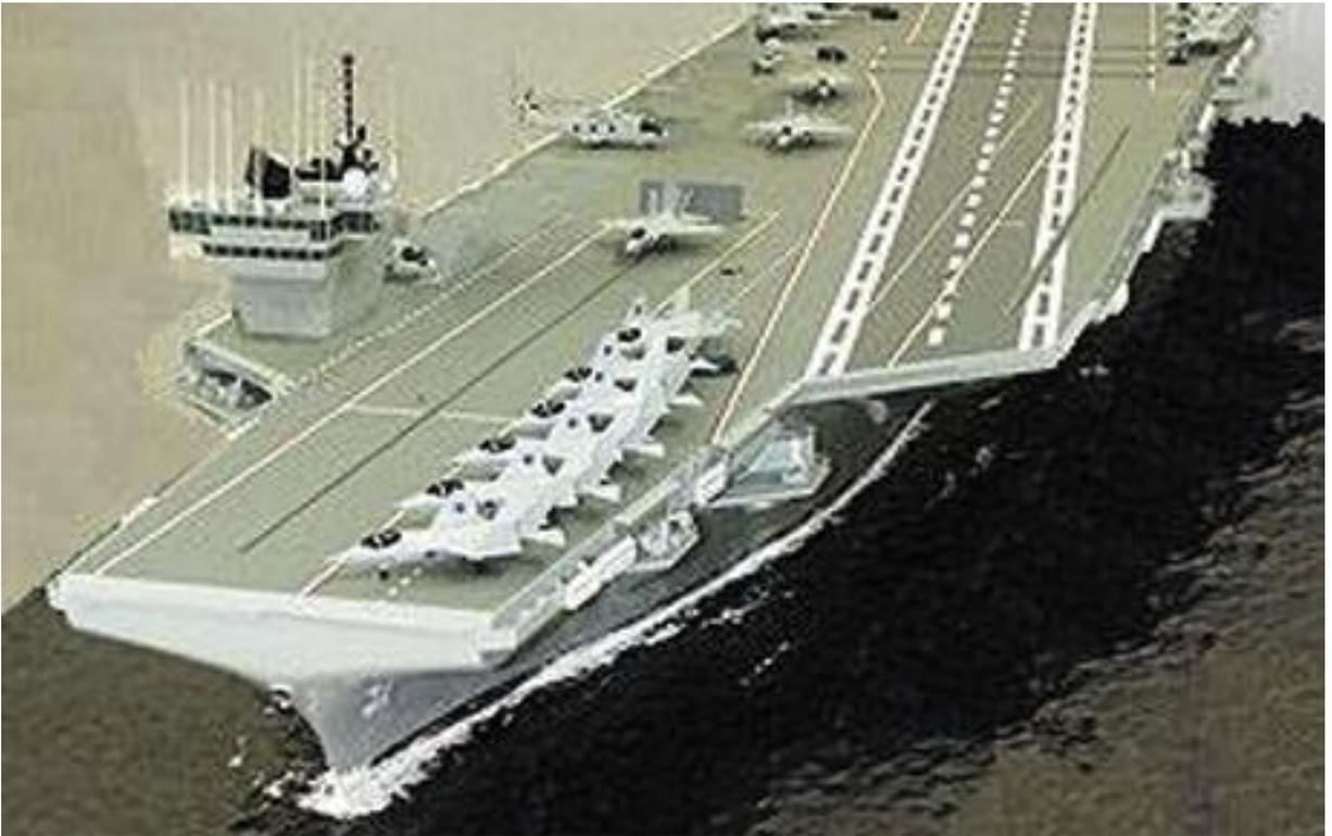
*Silhouette caractéristique du PAN2 : L'îlot (dont le positionnement est « libre » du fait de l'absence de cheminées) est placé le plus possible à l'avant tribord, protégeant l'ascenseur avant, procurant la place de parking maximale pour les avions et minimisant les perturbations aérauliques à l'appontage.*
