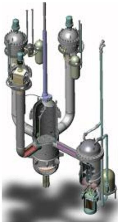
Schéma du réacteur expérimental ALLEGRO, réacteur à neutrons rapides refroidi au gaz
