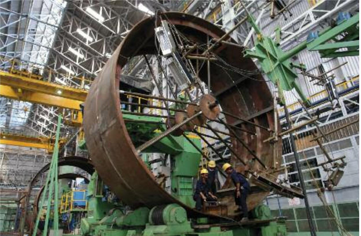
*Construction par le chantier naval indien Mazagon Docks Ltd de Mumbai (Bombay) de sections de coques épaisses pour les 6 sous-marins Scorpène construits localement sous licence. Le contrat a été signé en 2005.*
