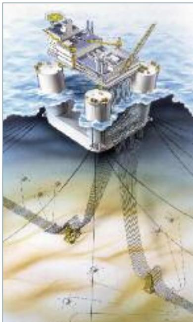
Figure 6 : Exemple de semi-submersible
