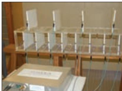
Réseau d'antennes (4 antennes émettrices et 8 antennes réceptrices) du radar MIMO (Multiple Input Multiple Output) Ultra Large Bande (500 MHz ; 5 GHz) développé par l'ONERA/DEMIR et le LEAT (Université de Nice).
