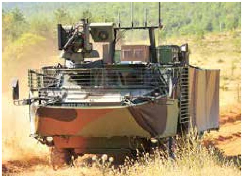
VAB ULTIMA de RTD, au niveau de protection élevé contre les IED, équipé d'un brouilleur (portique avec les 5 antennes)
