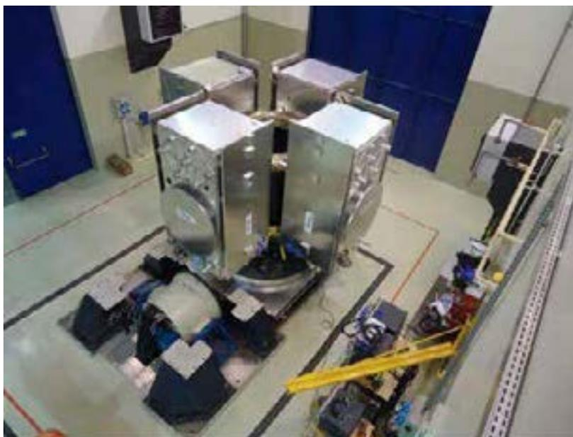
Quatre satellites Galileo sont montés sur leur dispenseur multiple pour le premier lancement quadruple Ariane 5 ES Galileo prévu à l'automne 2016.
