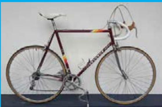
Vélo Peugeot PX10 1984, construit en tubes Reynolds 531 à l'usine de Mandœuvre (Doubs)
