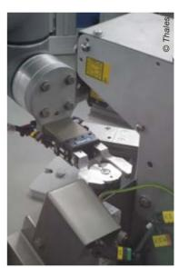
Robot d'inspection profilomètrique 3D
