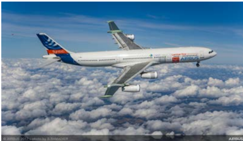
Démonstrateur sur les ailes laminaires pour améliorer la performance environnementale, projet soutenu par Cleau Sky 2
