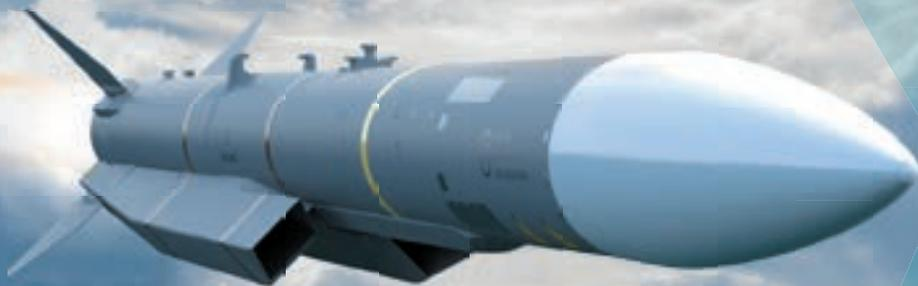
Conçu pour assurer des missions de supériorité aérienne, le missile air-air Meteor propulsé par statoréacteur est capable d'intercepter des cibles à très longue portée avec une zone d'interception nettement supérieure à celle des missiles de même gamme actuellement en service. Acquis par la France, le Royaume-Uni, l'Allemagne, l'Italie, l'Espagne et la Suède, il est aujourd'hui intégré sur les avions de combat de dernière génération.
