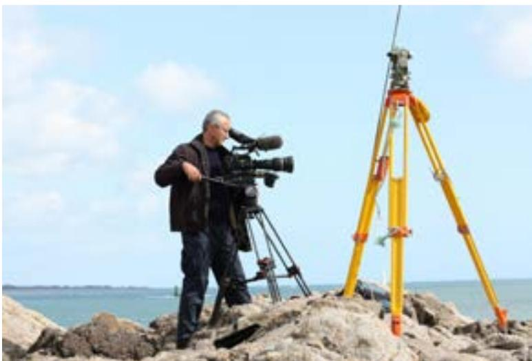
Photographie de tournage du film profil au top - théodolite en station pour le guidage par radio de la vedette sur le profil de sondage
