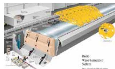
Le bassin de traction de 600 mètres, schéma du générateur de vagues
