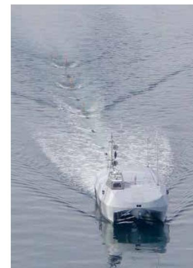
Drone de surface Sterenn Du, pièce maîtresse du contrat ESPADON, tractant une drague à influence magnétique et acoustique lors des essais conduits à Brest, en 2013, dans le cadre d'une étude avec l'Agence Européenne de Défense (AED)
