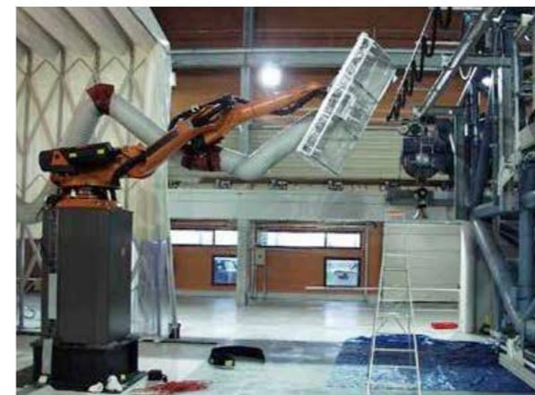
Plate-forme (représentant la station internationale) en phase de simulation d'approche finale du Robot (représentant l'ATV)
