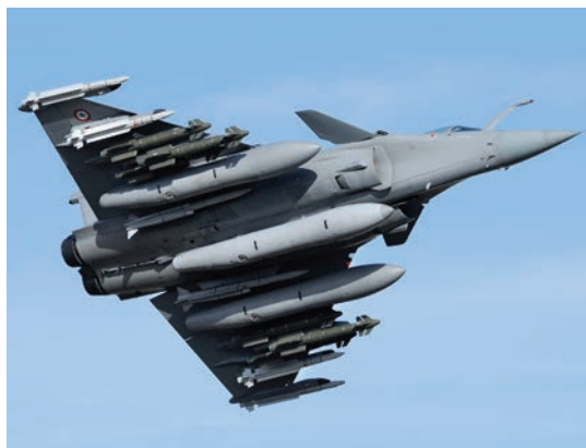
Saint-Cloud, le 23 janvier 2014 - Le Rafale a effectué avec succès ses premiers vols d'essais dans une nouvelle configuration très lourdement armée, comprenant 6 missiles air-sol de précision AASM Hammer, 4 missiles air-air moyenne et longue portée de la famille MICA, 2 missiles Meteor très longue portée ainsi que 3 réservoirs de 2 000 litres. Ces travaux préliminaires, financés sur fonds propres de Dassault Aviation et qui aboutiront à une ouverture complète du domaine de vol, sont le fruit d'une collaboration avec la Direction Générale de l'Armement. © Dassault Aviation - V. Almansa
