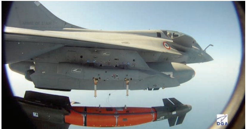
Tir de qualification d'un AASM laser – résultat d'une instrumentation vidéo
