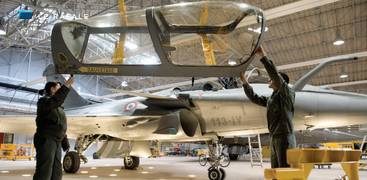
Pose d'une verrière sur un Rafale de l'armée de l'air sur la Base Aérienne 113 Saint Dizier.
