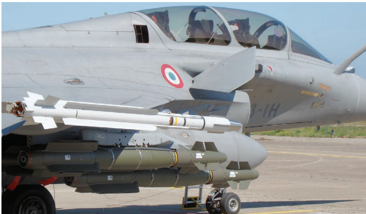
Les AASM en emport triple (en bas) et le MICA IR (en haut)
