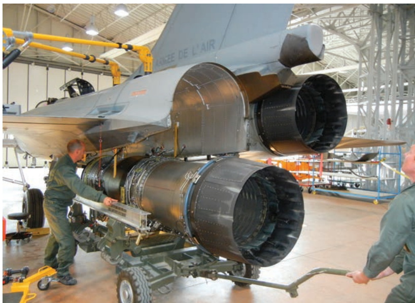
L'intégration du moteur dans le Rafale permet un accès très simple et un temps record de pose - dépose.
