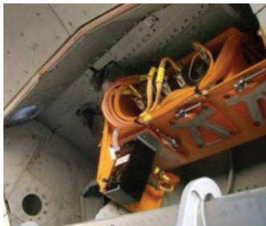
Kit enregistreur intégral des bus avion, pouvant équiper des Rafale de série
