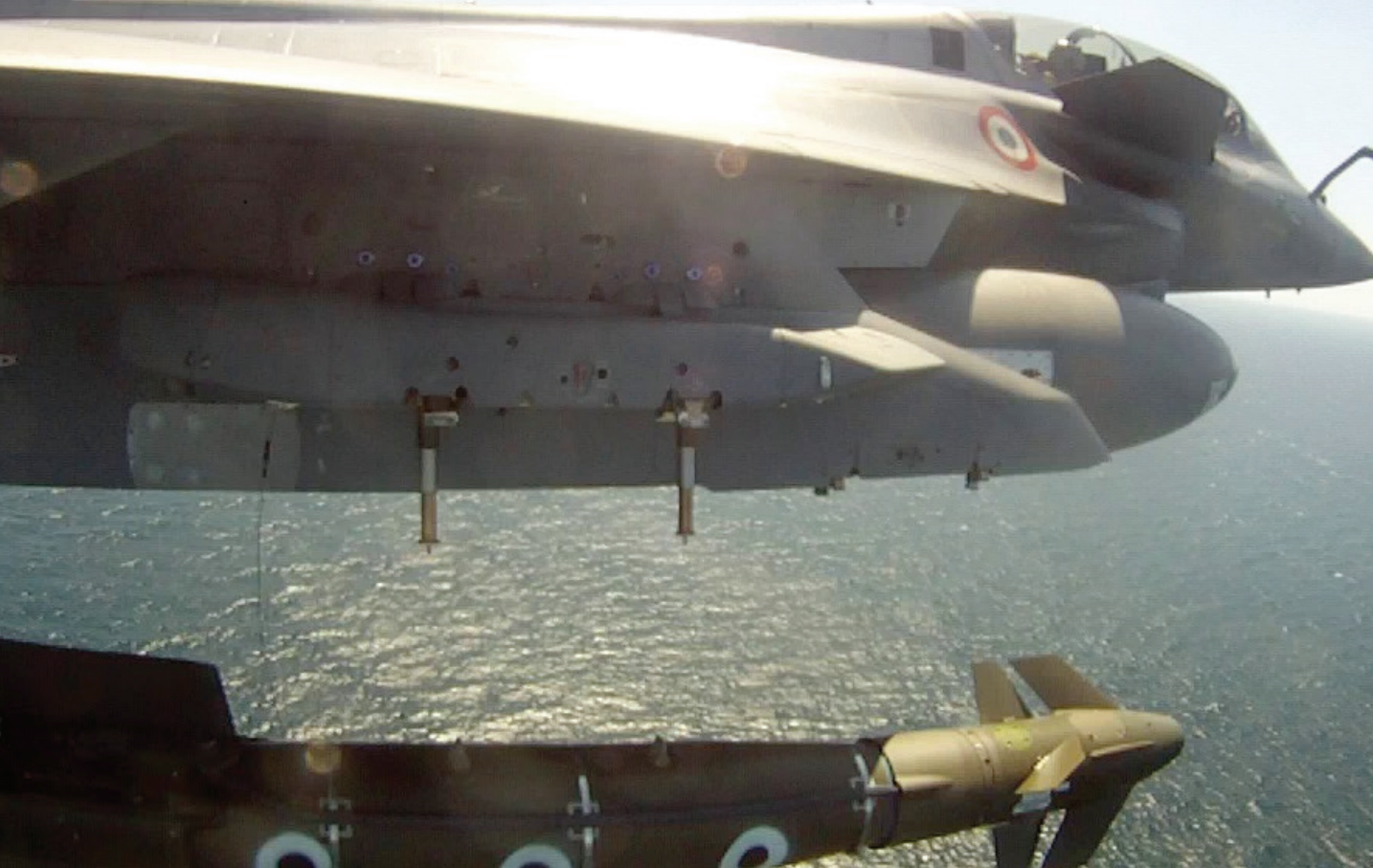
Les équipements RAFAUT sous RAFALE du haut (l'aile) vers le bas (la bombe AASM en cours de séparation) : le pylône PU708, le tribombe AT730, l'éjecteur 14" TG480 (pistons détendus) et le fil de sécurité largable.
