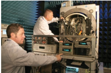
Test du RBE 2 AESA en chambre anéchoïque, site Thales à Elancourt - © Yves Kervel - I3M ©Thales
