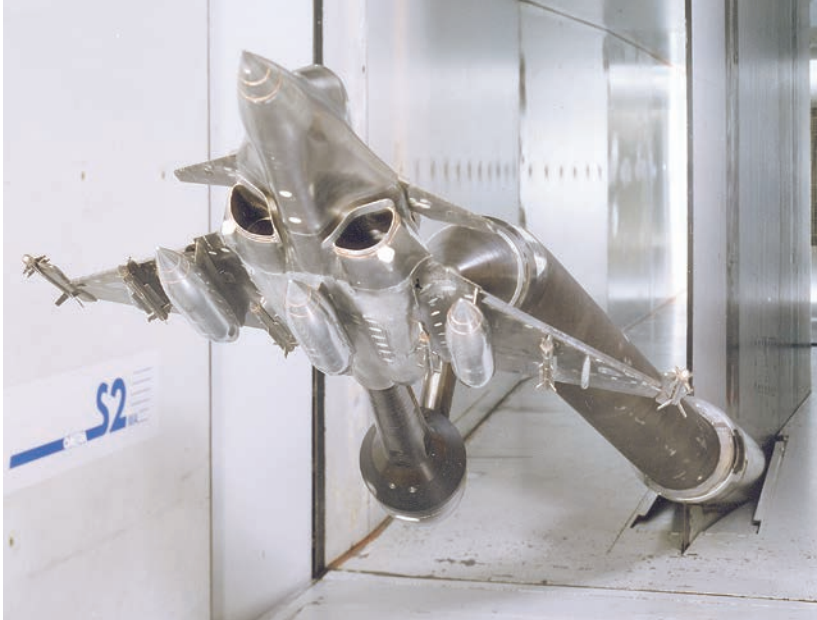
Essais à haute incidence du Rafale dans la veine transsonique de la soufflerie S2MA
