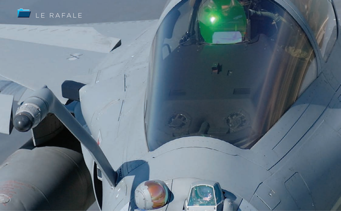
L'OSF, Optronique Secteur Frontal, avec la voie Infrarouge de SAGEM (à gauche)
