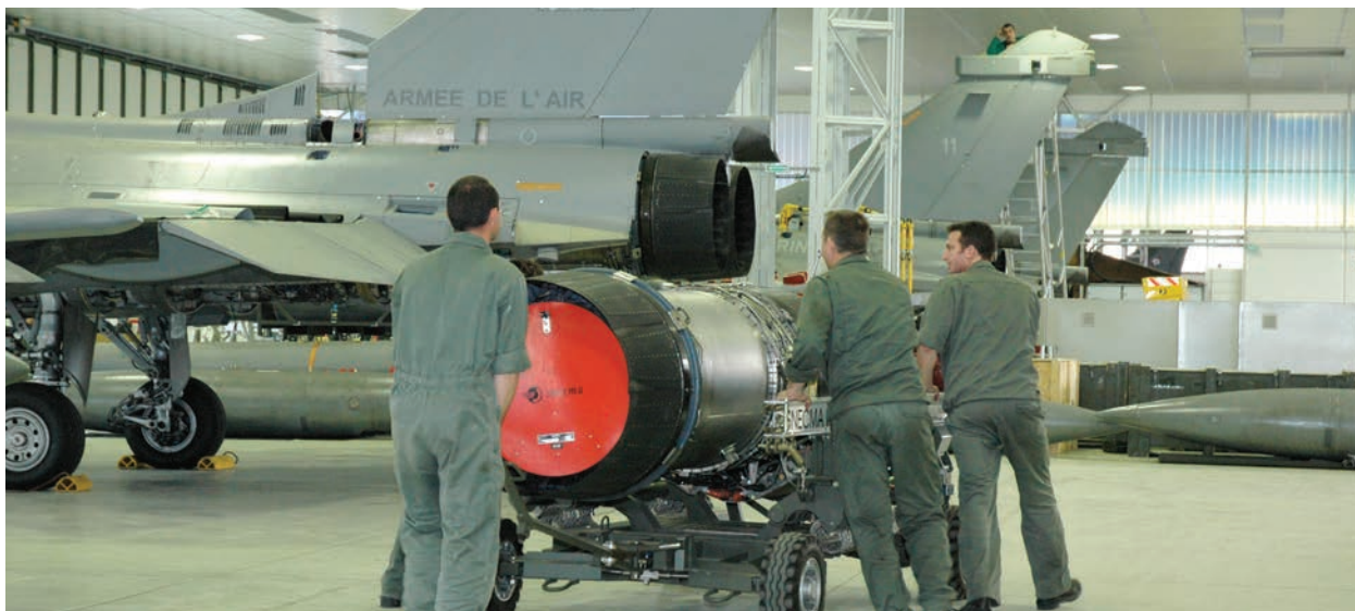
Préparation d'un réacteur M88 avant sa pose sur un Rafale.
