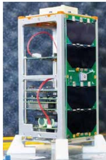
Modèle de vol de X-CubeSat
