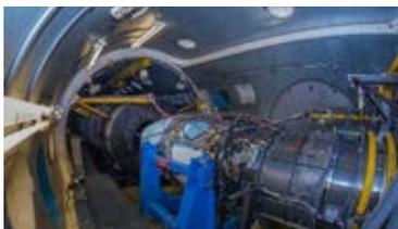
Essai de turboréacteur en caisson simulant les conditions atmosphériques représentatives d'un vol sous avion
