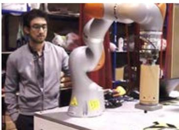
Essai d'un cobot sur un poste d'assemblage mécanique.
