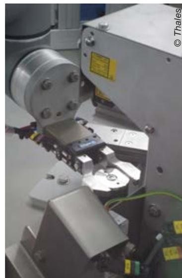
Robot d'inspection profilométrique 3D
