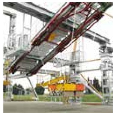
Essai au sol d'un impact de charge sur ME-DYNA
