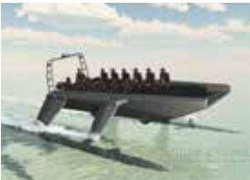
Amphibie aux foils rétractables : remarquer les rouleaux sous la coque (dessin Turgis & Gaillard)
