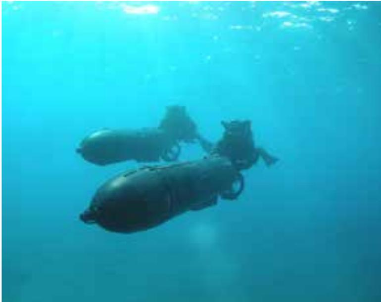
PSM, propulseur sous-marin défini par le commando Hubert, et appareil respiratoire à recycler
