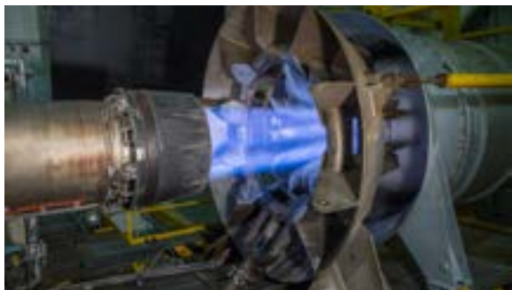
Moteur M88 en essai au banc T0 de DGA Essais propulseurs
