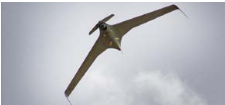
Orbiter 3, un drone israélien transportable par véhicule emportant 5kg de charge utile jusqu'à 150 km
