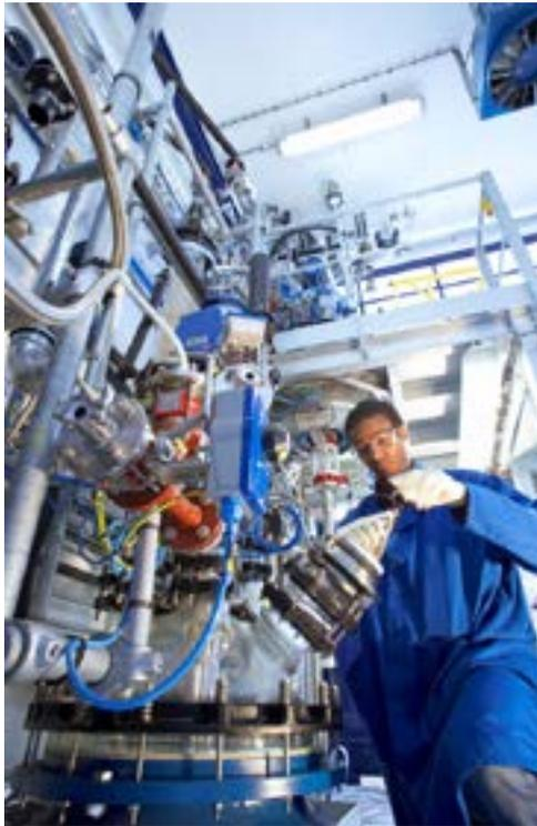
Pilote de chimie : montée en échelle de procédés avant transfert sur site industriel et production d'ingrédients nouveaux en quantité suffisante pour essais représentatifs
