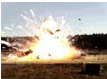
Essai d'échauffement lent sur propulseur
