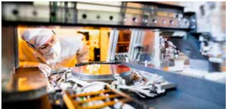
Salle blanche CEA Leti : démontage d'un substrat de nitrure de gallium - @Andréa AUBERT/CEA
