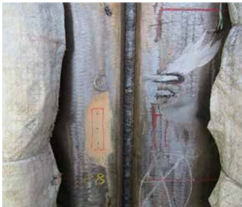
Soudage en cours de la partie avant du SNA Saphir et de la partie arrière du SNA Perle pour reconstituer le SNA Perle réparé ; figurent de part et d'autre des tapis chauffants pour maintenir l'acier spécial de coque à température avant et après soudage et éviter la formation de fissures à cœur
