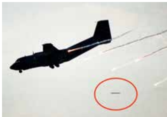
Essais de systèmes d'autoprotection sur C160 au Centre d'essais en vol (maintenant DGA EV) dans les années 1990
