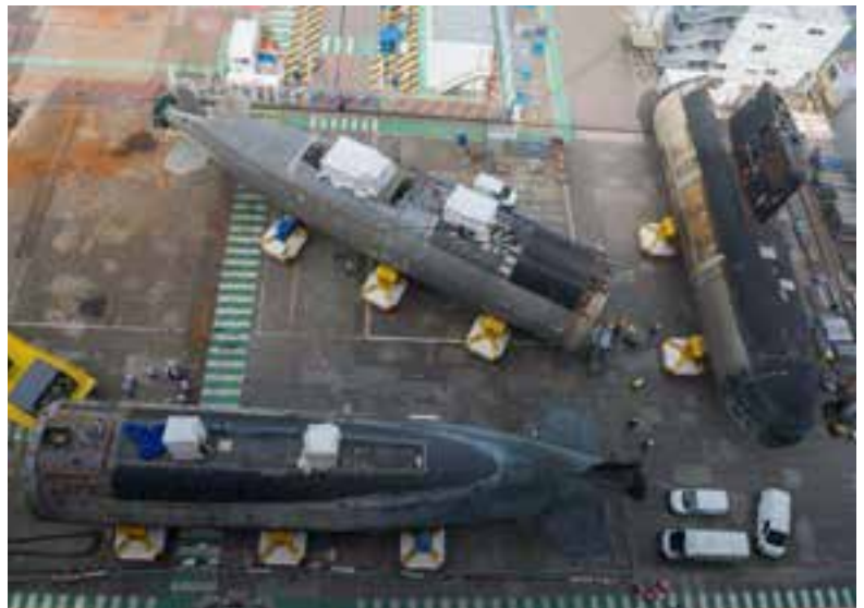
Déplacement des demi-coques de SNA à Cherbourg avant la jonction des 2 moitiés constituant le nouveau SNA Perle ; en haut, arrière de la Perle , en bas, arrière du Saphir , à droite, l'avant du Saphir
