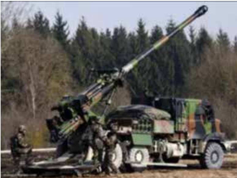
En trois minutes, le CAESAR arrive sur site, envoie six obus à plus de 40km avec une précision de 50m et repart
