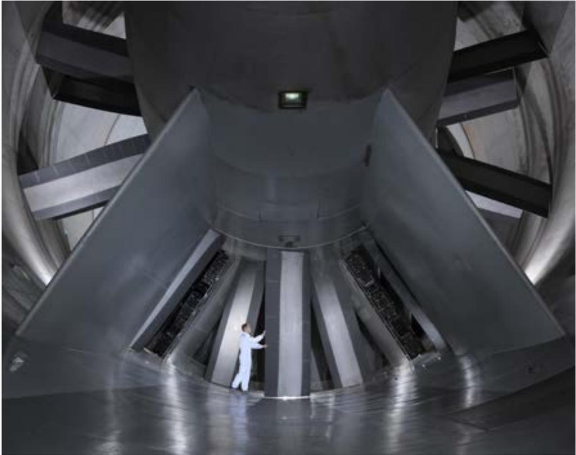
Un ventilateur de la soufflerie avec ses pales acier et composite. Jusqu'à 10 tonnes d'air par seconde
