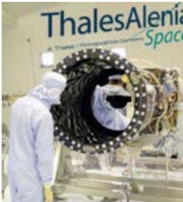
Instruments et miroir du satellite Pléiades qui permettra une résolution de 50 cm
