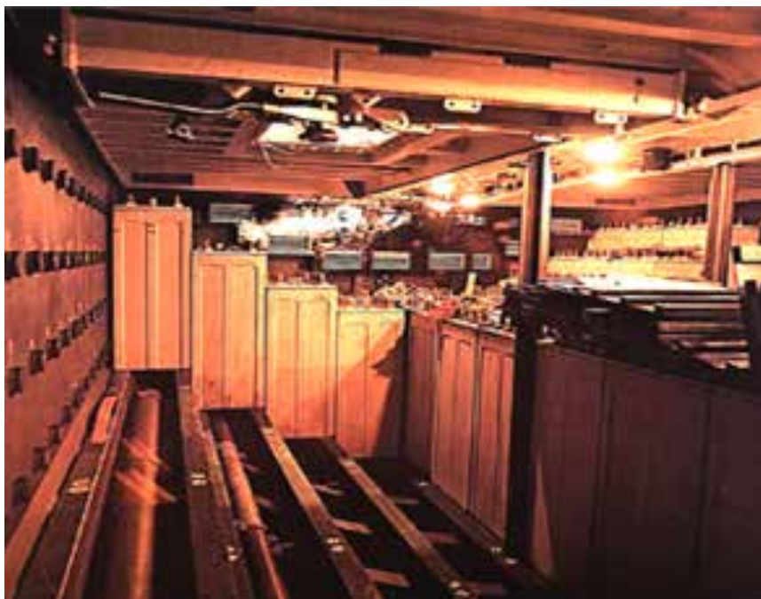
Compartiment batterie d'un sous-marin classique (SSK) type Agosta
