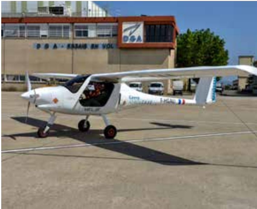
Le Velis Electro, de Pipistrel, est le premier avion électrique certifié par l'EASA
