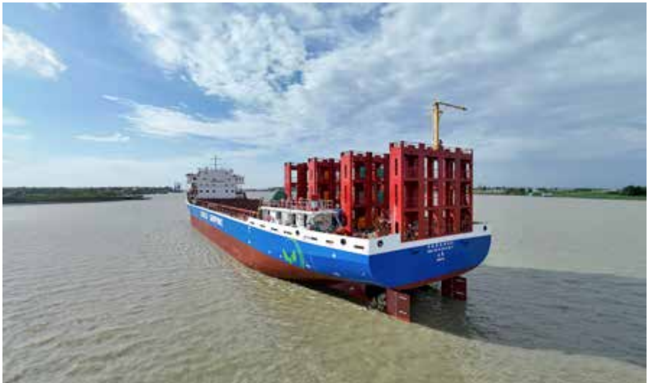
Long de 120 mètres, large de 24 mètres, ce navire de 10 000t du chinois Cosco Shipping Heavy Industry dispose d'une capacité de charge de 700 conteneurs EVP. Sa propulsion est assurée par deux moteurs principaux de 900 kW, alimentés par 36 "batteries-conteneurs". Un sister-ship est en construction.
