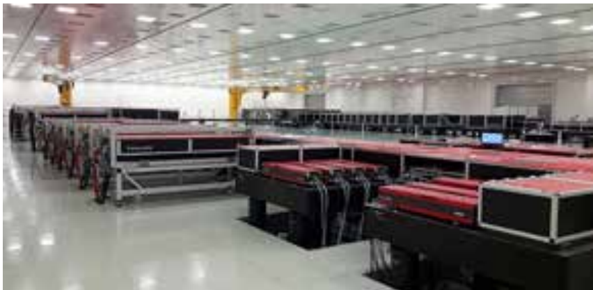
Installation ELI-NP (Extreme Light Infrastructure for Nuclear Physics) en Roumanie, laser le plus puissant au monde délivrant des impulsions de 10 PetaWatts
