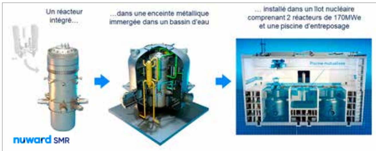
Une centrale de 340 MWe comprenant 2 réacteurs intégrés
