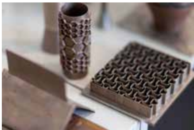
Figure 1 : Les matériaux développés par le projet COMPOSITES, à la fois légers et absorbants, pourraient servir à l'équipement des combattants et des véhicules.
