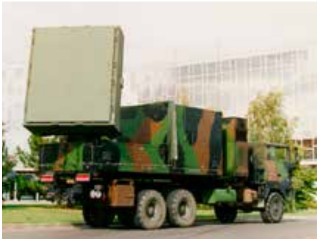
Le radar COBRA donne les coordonnées d'origine et d'arrivée des obus et roquettes trajectographiés
