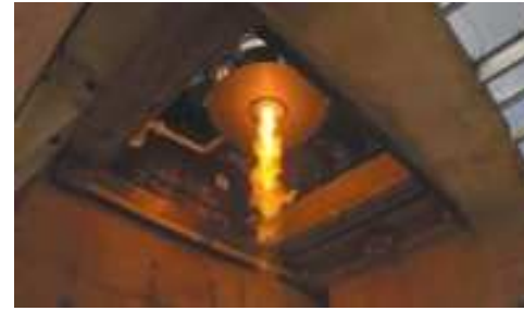
Premier tir du moteur fusée hybride de HyPrSpace sur un banc de DGA Essais Missiles site Gironde en juillet 2024 © HyPrSpace
