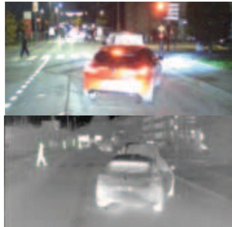
Fig. 5 : Détection de piétons pour l'application automobile
