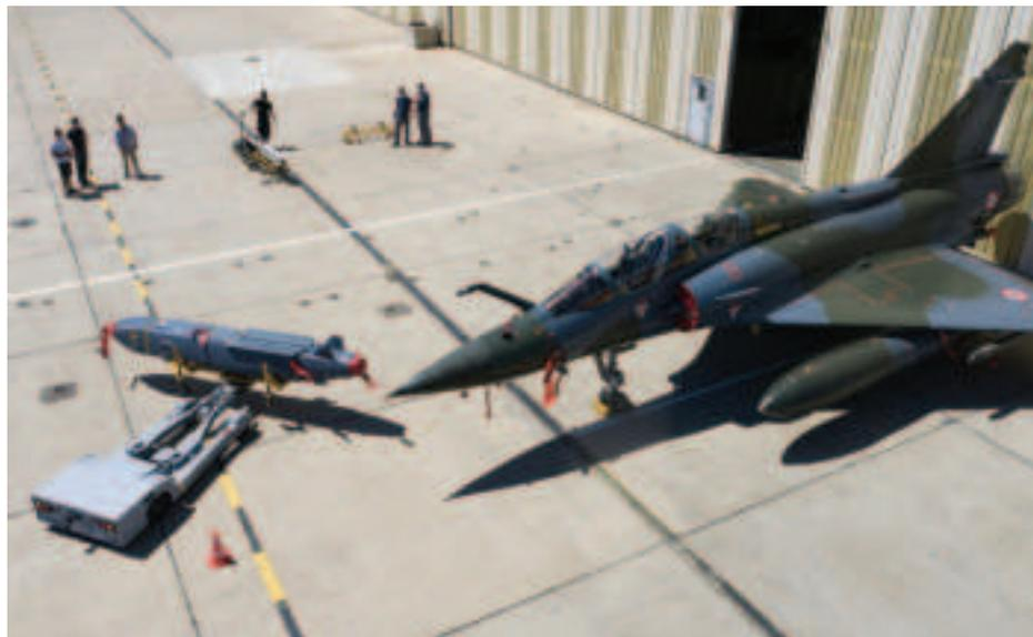
Le Sefiam 1602, un matériel de mise à poste d'armement, électrique et radiocommandé compatible des 14 points d'emport du Rafale
