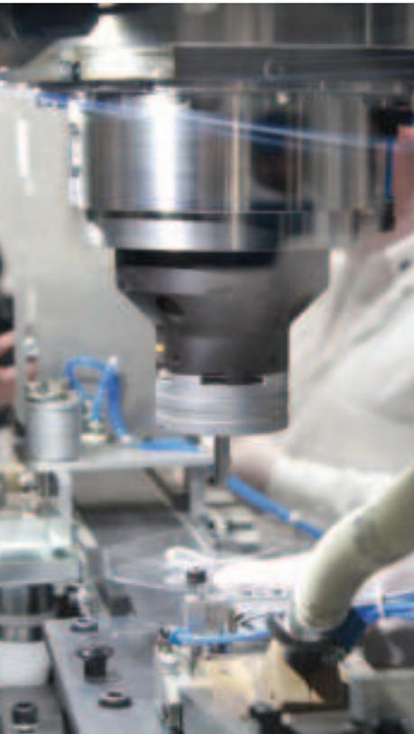
Fabrication de céramiques semi-conductrices pour bougies aéronautiques
