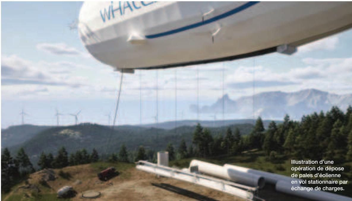
Illustration d'une opération de dépose de pales d'éolienne en vol stationnaire par échange de charges.
