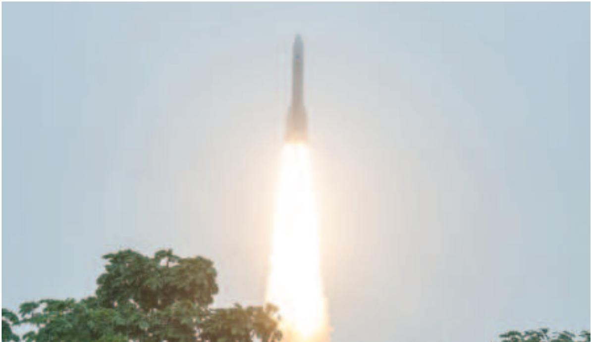
Le premier des 5 vols d'Ariane prévus en 2025. Innovation, le moteur Vinci peut se rallumer plusieurs fois. Il a permis à l'étage supérieur de replonger dans l'atmosphère après déploiement du satellite CSO 3.
