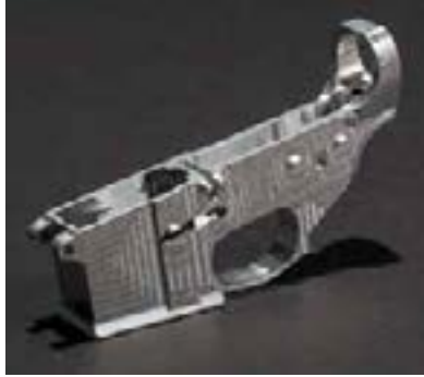
Pièce de fusil d'assault AR-15 imprimée à partir d'une imprimante 3D et de plans trouvés sur internet © Wired Magazine.
